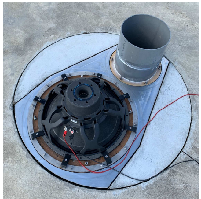
Figure 7 Montage du 18LEX1600Nd "à l'envers"
